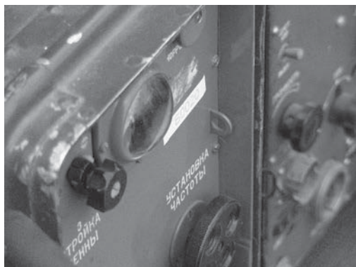
Линза на радиостанции — читать мелкую шкалу
