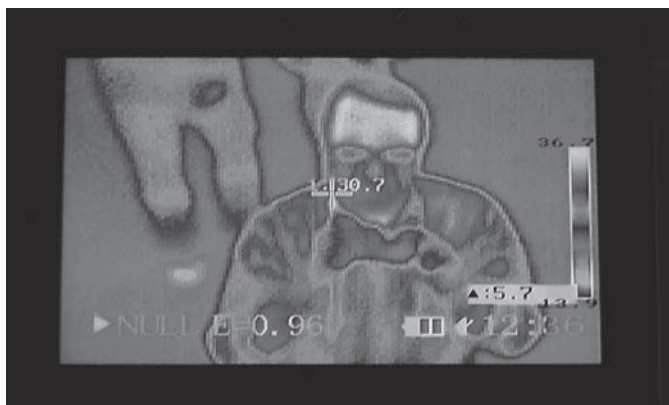
ИК-фотография автора, шкала температур справа, холоднее всего – фотоаппарат, который автор держит в руках
