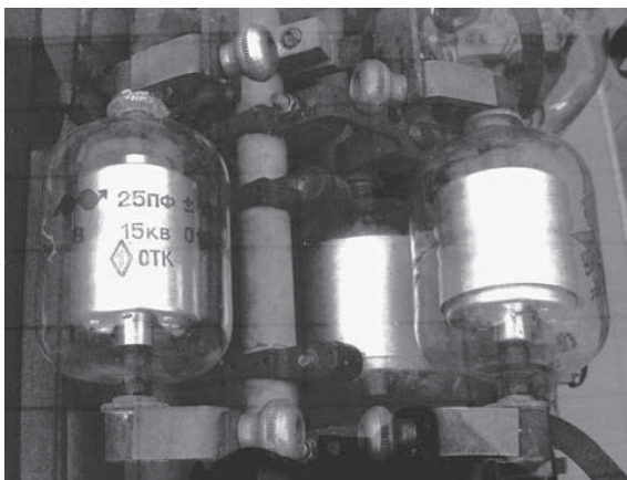
Вакуумный конденсатор (25 пФ, 15 кВ)
