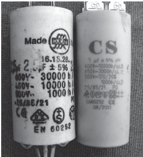
Срок службы конденсаторов уменьшается с увеличением напряжения, процессы в изоляции ее разрушают
