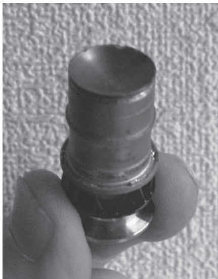
Импрегнированный катод, губка W (вольфрама), пропитанная солями соединений Ba (бария)
