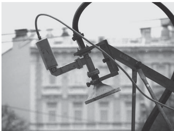
Волновод для передачи электромагнитной волны на частоте около 10 ГГц, его серебрят изнутри (здесь и далее все фотографии сделаны автором, если не указано иное)
