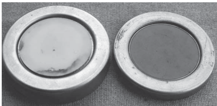
Выводы энергии мощных сверхвысокочастотных приборов, на левом внизу – след пробоя, металлизированный (блестящий) участок
