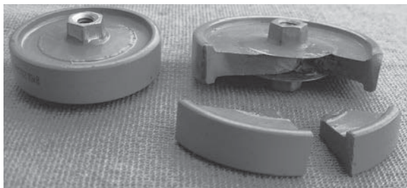
Конденсатор; при пробое давление в канале пробоя было таким, что керамика раскололась
